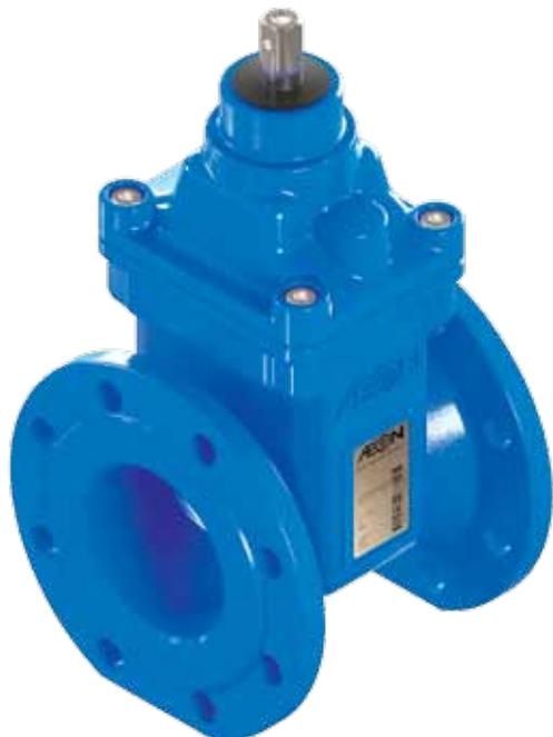
Уплотнение клина резиной NBR позволяет устанавливать задвижки на трубопроводах, транспортирующих канализационные и сточные воды (с включением твердых частиц). Запатентованная конструкция задвижки с обрeзиненным клином NBR с двойным уплотнением обеспечивает герметичность класса А на протяжении всего срока эксплуатации.
