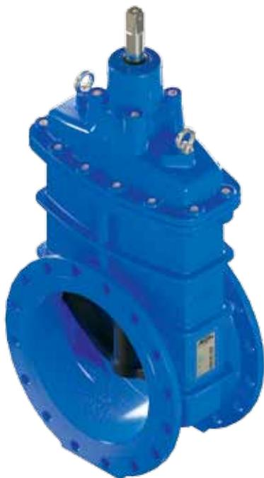
Запатентованная конструкция задвижки с обрешиненным клином с двойным уплотнением обеспечивает 100% герметичность класса А в сочетании с низким крутящим моментом и минимальным числом оборотов ЗАКРЫТИЯ/ОТКРЫТИЯ.
