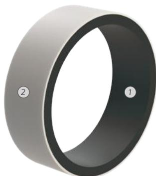
1. Несущий слой напорной трубы из ПЭ 100 или ПЭ 100-RC. Толщина зависит от номинального давления (PN). По согласованию с Заказчиком возможно изготовление данного слоя из PE-RT тип II для применения при повышенной температуре транспортируемой среды.
