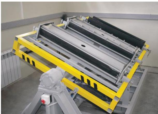
Суть метода состоит в измерении величины износа отрезка полимерной трубы смесью воды и крупных абразивных частиц (средний размер 6 мм). Движение смеси обеспечивается изменением наклона образца на  $\pm 22,5^\circ$  с частотой 20 циклов в минуту.
