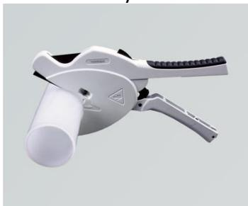
Режущие лезвия изготовлены из стали «Золинген» производят чистый, прямой разрез труб из ПП, ПЭ, РЕ-Х, ПБ, ПВДФ. Ножницы оснащены механизмом автоматического выдвижения лезвия из корпуса. Эргономические ручки обеспечивает максимальное удобство в работе. Конструкция ножниц гарантирует точность при резке и длительный срок службы при профессиональном использовании.
