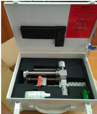
**Позиционеры** HÜRNER применяются для установки, выравнивания ПЭ-труб, а также для снятия внешних нагрузок в зоне соединения перед сваркой с помощью деталей с закладными нагревателями.
