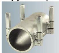
Накладка состоит из двух широких металлических сегментов, при стягивании их друг другу с помощью винта на полиэтиленовой трубе удаляется овальность, и труба приобретает круглую форму.
