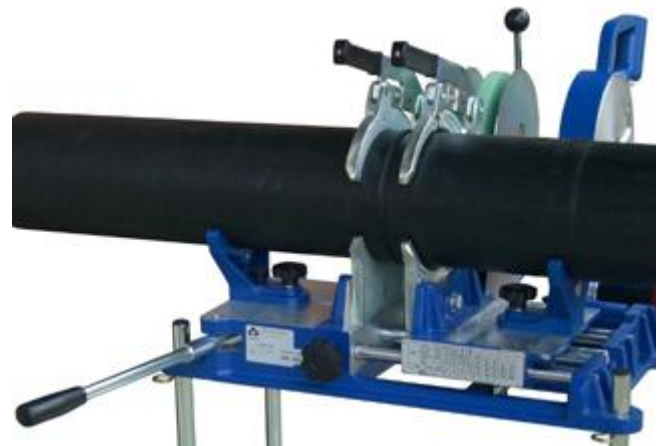
Рис. 10 Перестановка и осадка
