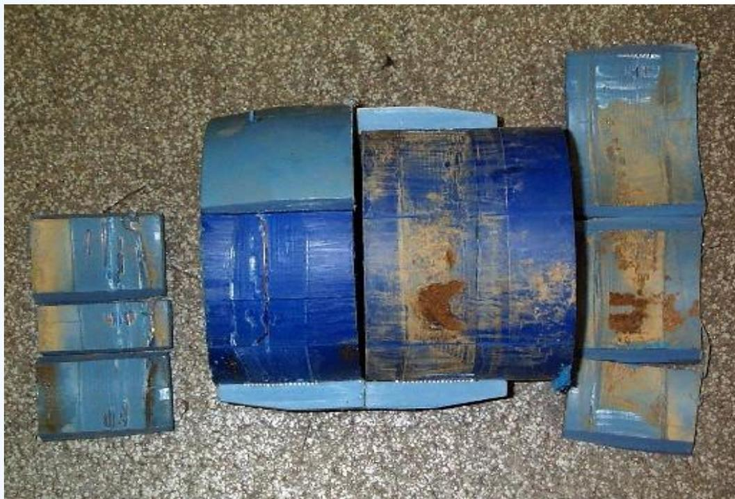
*Пример: в данном случае на лицо отсутствие очистных устройств и средств обезжиривания, кроме того – низкий уровень качества сварочных работ.*
