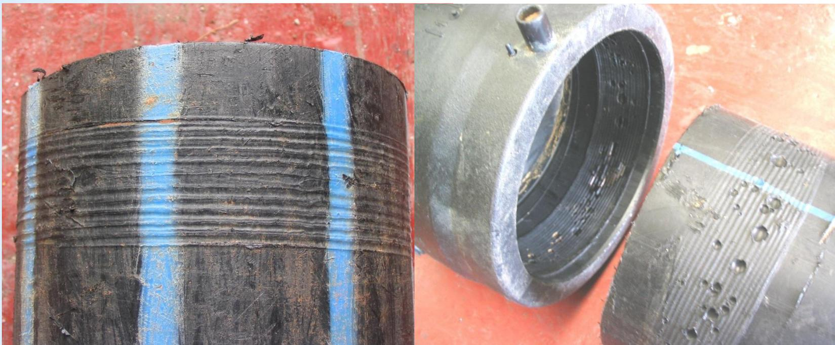
**Пример:** в данном случае пытались сварить трубу без снятия оксидного слоя. На фото слева труба не очищена от грязи и не обезжирена, а справа торец трубы вдобавок был мокрым.
