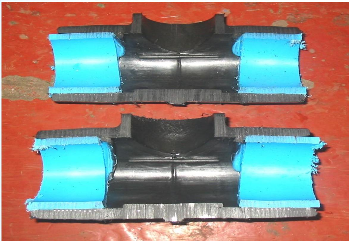
*Пример: здесь косой срез возник из-за отсутствия трубореза и нарушено позиционирование.*
