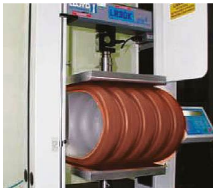
Рисунок 2. Кольцевая гибкость в соответствии с ГОСТ Р 54475-2011 (п. 8.5), ТУ 22.21.21-078-73011750-2021 (п. 4.6)
