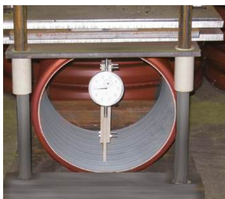
Рисунок 3. Коэффициент ползучести материала в соответствии с ГОСТ Р 54475-2011 (п. 8.7), ТУ 22.21.21-078-73011750-2021 (п. 4.11)
